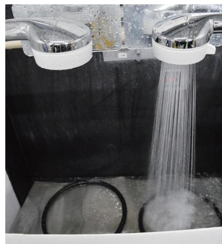
③ 心地良いシャワーにするために、丸い輪を置いて、その中にシャワーの水が収まるように、水の出方の検査をしているよ。
