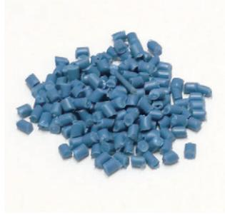
⊖ これは、この会社で使っている、プラスチックをリサイクルした原料の1つだよ。海へプラスチックが流れてしまうことを防ぐために回収されたものがリサイクルされているんだ。
