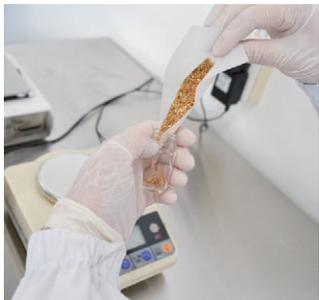
② 0.01g単位で計量して瓶に詰めるよ。機械では難しい作業なので、1本ずつ人の手で行ってるんだ。金箔は少しの風でも舞い上がってしまうので、風の当たらない場所で瓶詰をしているよ。
