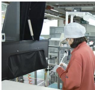
⊖ ドアイルミネーションの部品は、異物が混ざると、光を遮り、きれいに光らないんだ。部品に不具合はないか、光り方を確認し、異物がないことを、必ず人の目で確認しているよ。
