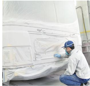
⌚ デザインバスは、バスごとに形が変わるため、ほとんどを手作業で作るんだ。塗装も、バス1台を全て人の手で行うよ。その日の気温や湿度に合わせて、毎回、塗り方を変えているんだ。
