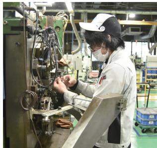
③ 当たり前前に品質を維持できるように、毎日機械の整備を行っているよ。小さな部品でも、車の「安全」と「快適」を支える重要なものだからね。出荷前に、機械と人の目で検査しているんだ。
