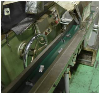
② 1日に約1000種類の部品を作っているよ。作る部品ごとに必要な強度が違うから、高温で熱した後、冷やす温度で強度を調整するんだ。冷やし方も部品に合わせて変えているよ。
