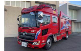
西部方面消防署川島分署の「水槽付消防ポンプ自動車」を更新しました。この消防車は1500リットルの水を積載でき、CAFS装置を備えた高性能の消防車です。
